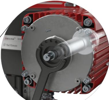
Embrayage à friction facilement accessible et réglable
